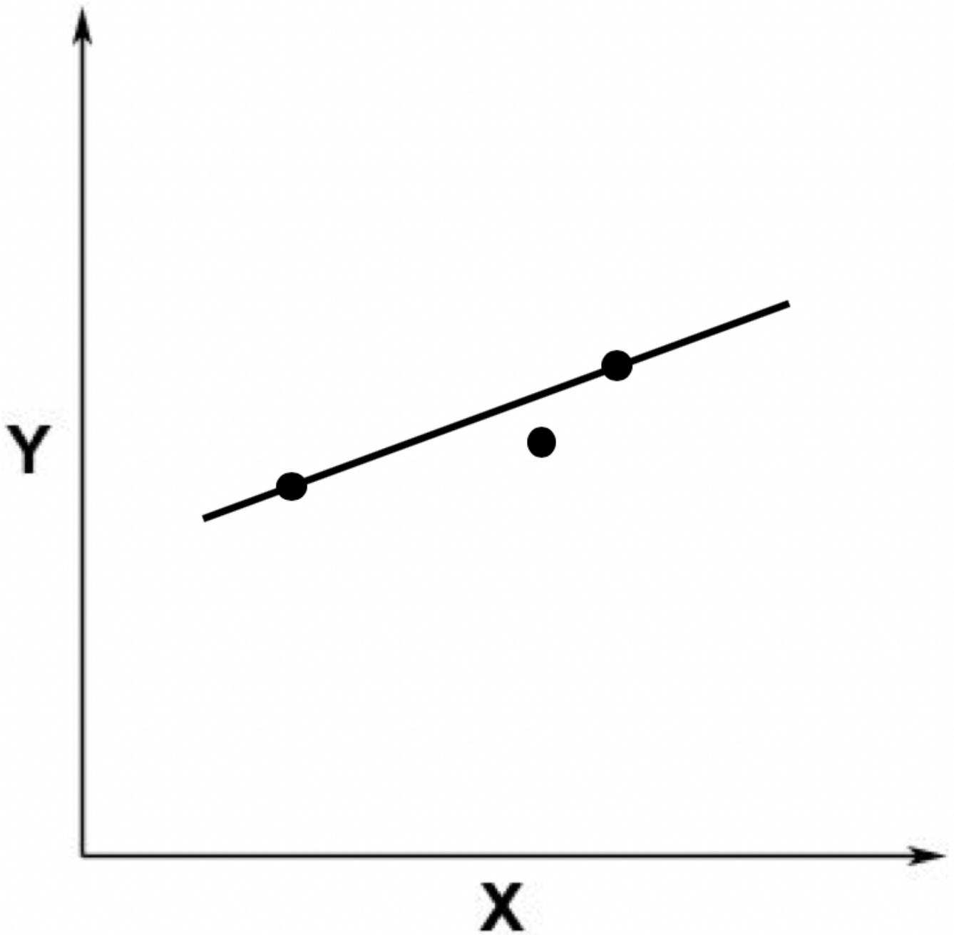
这个时候，从线性方程的角度来看，就不存在精确解了。因为没有哪条直线能同时穿过这三个点。这张图片也体现了线性回归分析和求解线性方程组是不一样的，线性回归并不需要求精确解。
