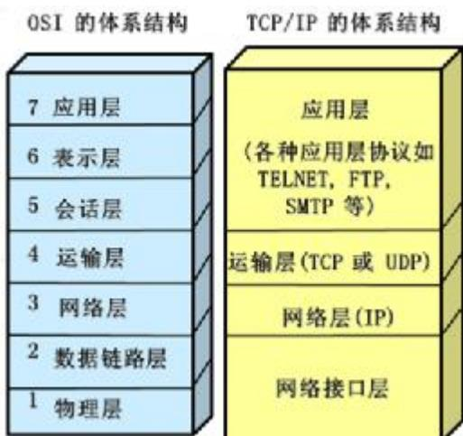
(3) 五层协议的体系结构：应用层、运输层、网际层、数据链路层和物理层。
