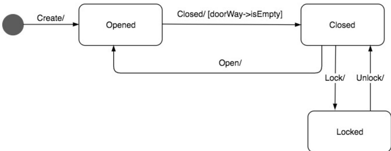
状态图要在**需求分析阶段**画，描述状态变迁的逻辑关系，在**详细设计阶段**也要画，这个时候，状态要用枚举值表示，以指导具体的开发。
