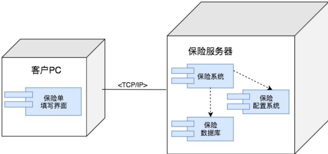
部署图是软件系统最终物理呈现的蓝图，根据部署图，所有相关者，诸如客户、老板、工程师都能清晰地了解到最终运行的系统在物理上是什么样子，和现有的系统服务器的关系，和第三方服务器的关系。根据部署图，还可以估算服务器和第三方软件的采购成本。
