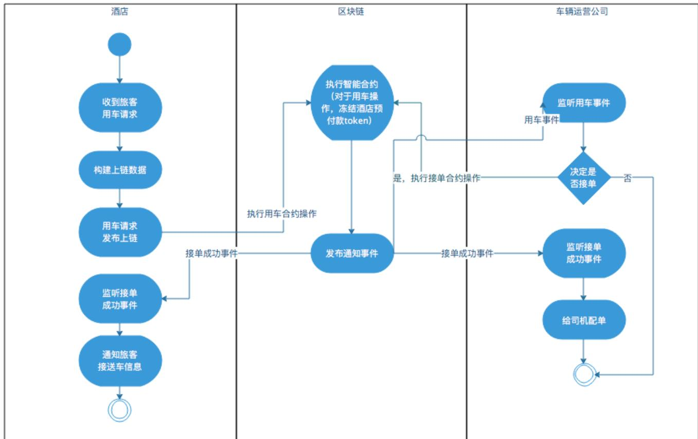
活动图和早期流程图的图形元素也很接近，实心圆代表流程开始，空心圆代表流程结束，圆角矩形表示活动，菱形表示分支判断。
