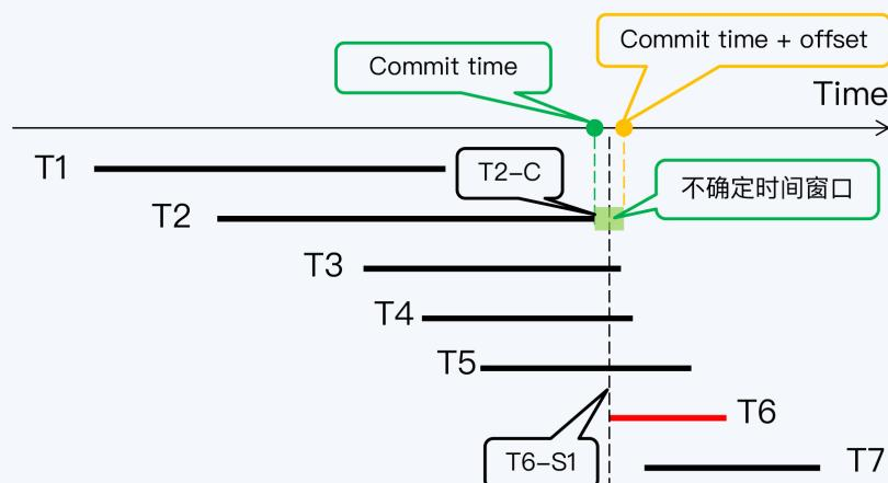
事务 T6 启动获得了一个时间戳 T6-S1，此时虽然事务 T2 已经在 T2-C 提交，但 T2-C 与 T6-S1 的间隔小于集群的时间偏移量，所以无法判断 T6 的提交是否真的早于 T2。
