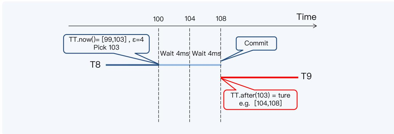
针对同一个数据项，事务 T8 和 T9 分别对进行写入和读取操作。T8 在绝对时间 100ms 的时候，调用  $TT.now()$  函数，得到一个时间区间  $[99, 103]$ ，选择最大值 103 作为提交时间戳，而后等待 8 毫秒（即  $2\epsilon$ ）后提交。
