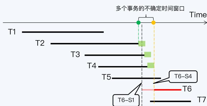
最后，当 T6 拿到时间戳 T6-S4 后，终于跳过了所有不确定时间窗口，读等待过程到此结束，T6 可以正式开始它的工作了。
