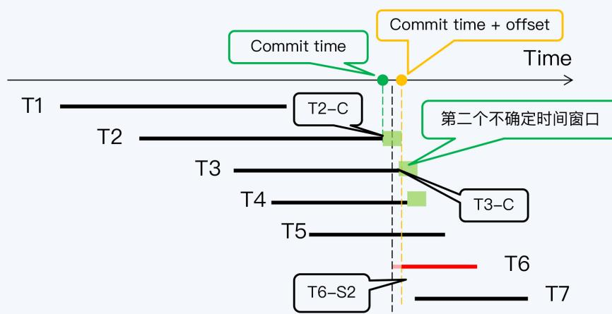
不过，接下来又出现更复杂的情况，T6-S2 与 T3 的提交时间戳 T3-C 间隔太近，又落入了 T3 的不确定时间窗口，所以 T6 事务还需要再次重启。而 T3 之后，T6 还要重启越过 T4 的不确定时间窗口。
