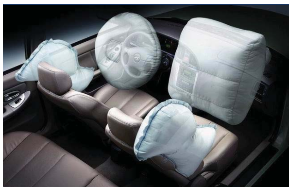
图 17：安全气囊示例（2 前+2 侧）
