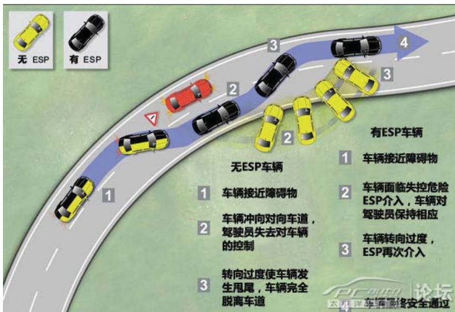
图 9：ESP 系统功效示例
