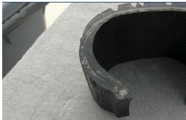
图 11：RSC 轮胎的加厚内壁
