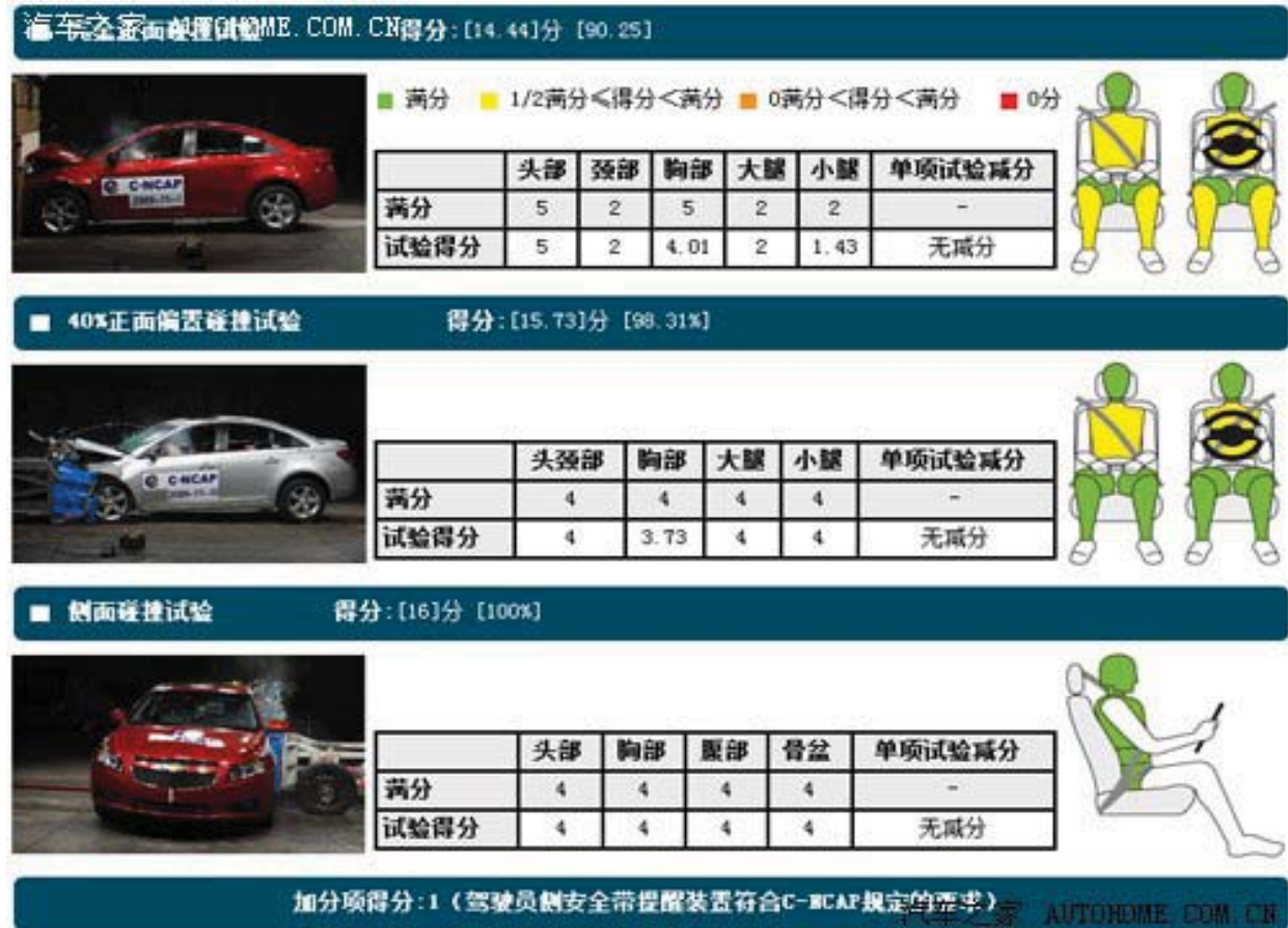
图 23: C-NCAP 碰撞试验及评分
