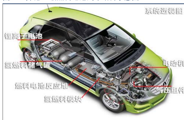
图 5：奔驰 B 级燃料电池汽车结构示意图
