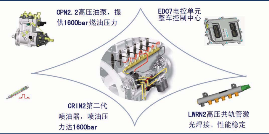
图 7：共轨系统的结构示意图（博世轻型）
