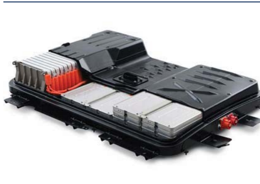
图 9：LEAF 使用的锰酸锂电池组
