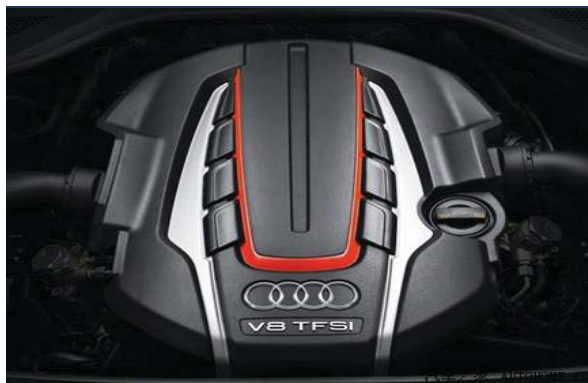
图 60：奥迪 S8 装备的 V8 双涡轮增压发动机
