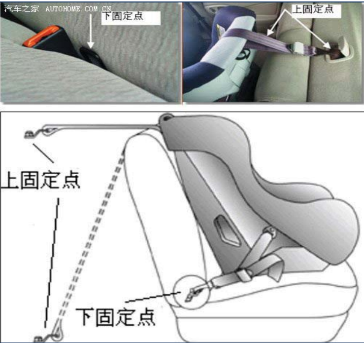
图 4：LATCH 接口儿童安全座椅的固定方式
