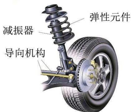
图 3：汽车悬挂系统结构图
