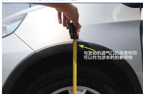
图 9：发动机进气口高度测量
