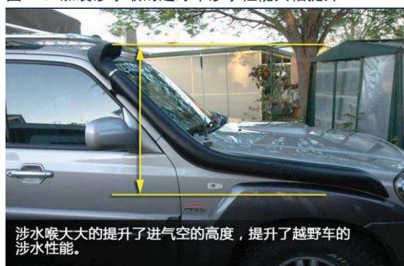
图 11：加装涉水喉的越野车涉水性能大幅提升
