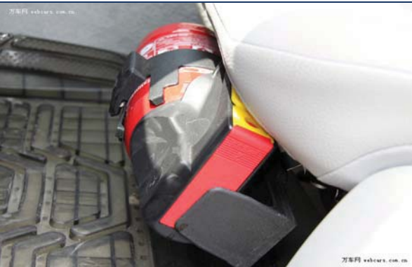
图 2：部分车型灭火器放置于驾驶员座椅下方（奔驰 C）
