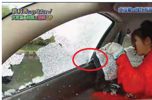
图 5：汽车座椅头枕如何弄碎玻璃（正确方法）
