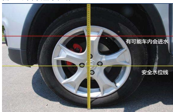
图 8：汽车安全水位线
