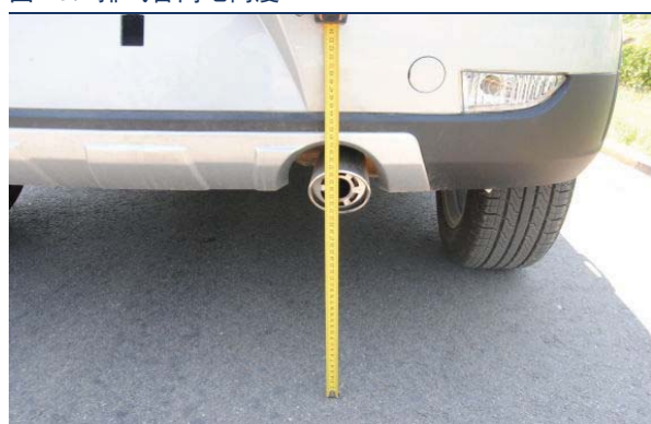
图 10：排气管离地高度
