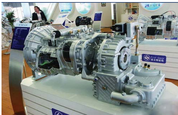
图 14：法士特铝合金壳体变速器
