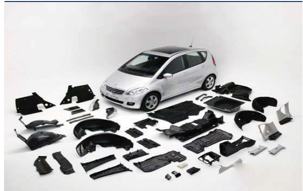
图 8：塑料材料在汽车内外饰中的应用
