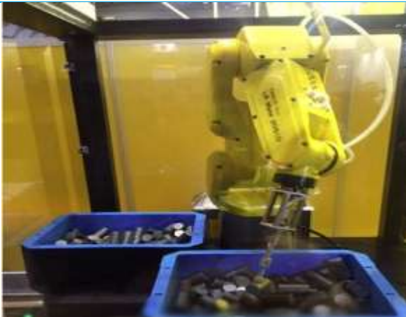
图表 83：FANUC 带深度学习功能的机器人
