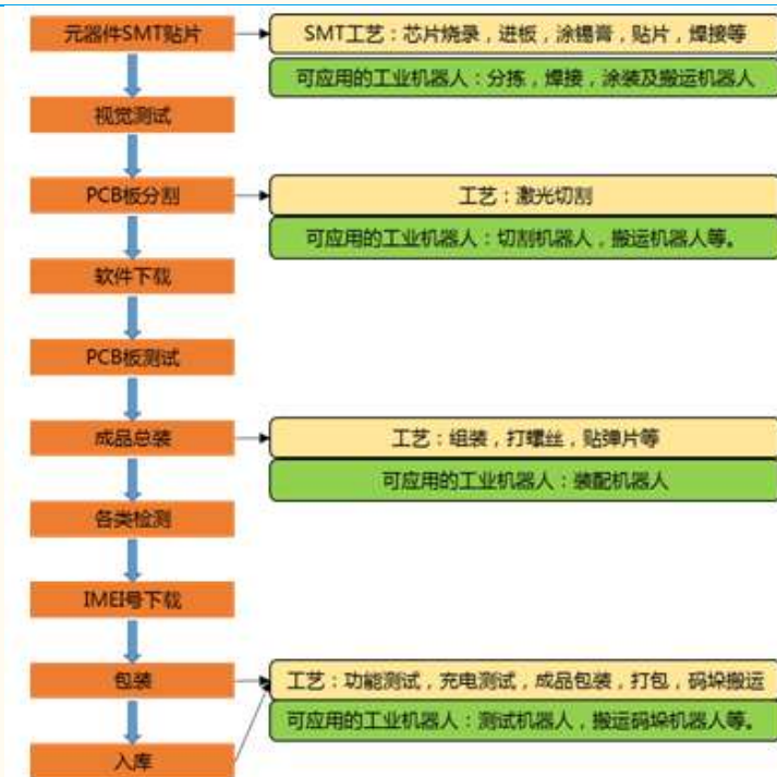
图表 70：手机生产的各个环节要用到不同类型的机器人
